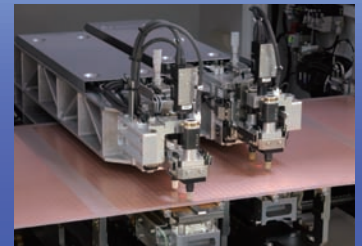
2ヘッド搭載・ダブルアーム Twin Punch Head & Twin Arm
