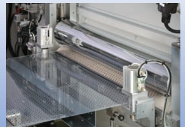
X & Y 張力制御式クランプ機構 X & Y Tension Control
