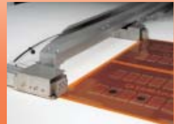
サイズ可変のX&Y張力把持機構により 薄物FPCにも対応 Size-adjustable X-Y tension clamp mechanism for thin FPC.
