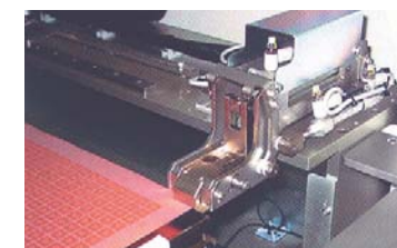
張力制御式クランプハンド XY Tension Clamp mechanism
